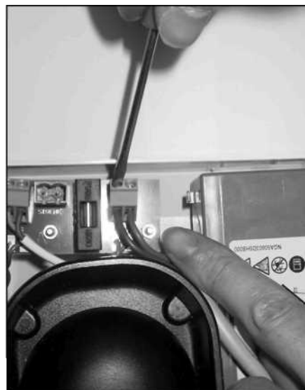
Figura 9b : Conexión de la alimentación
